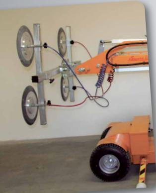
Le circuit de vide est divisé en deux boucles pour plus de sécurité. Voici les deux boucles avec des flexibles respectivement bleus et rouges.
